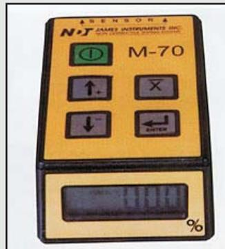
Um instrumento projetado para medir rápida e precisamente a quantidade de umidade de qualquer superfície.
