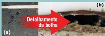
Neste corte verifica-se a presença de bolha na superfície do concreto protegido por revestimento epóxico.
