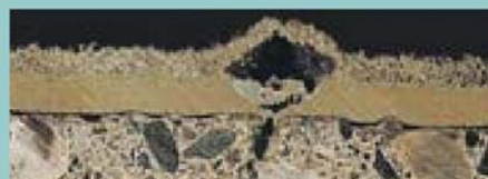
Neste corte verifica-se a presença de bolha na superfície do concreto protegido por revestimento epóxico.
