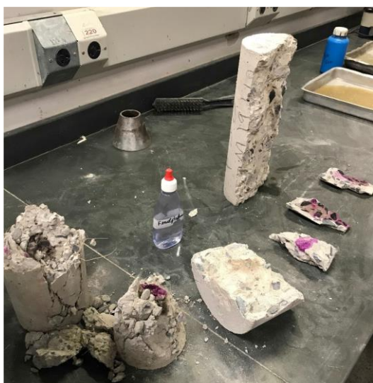
Figura 11: Corpos de prova com uso de fenolftaleína.
