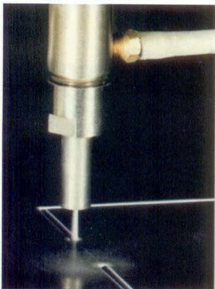
Hidro corte na indústria mecânica, substituindo as máquinas de corte por serra.
