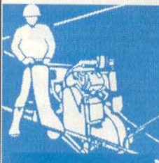
Serra Horizontal (Flat Saw) Até 40cm de esp.
