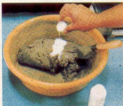
Figura 1 — Este material de recuperação tem consistência de bôlo duro. Um polímero é adicionado para melhorar a trabalhabilidade e suas características de aderência.
