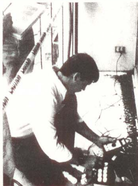
Este novíssimo e prático equipamento mede a quantidade de cloretos presente no concreto, oferecendo resultados na própria obra, em poucos minutos.
