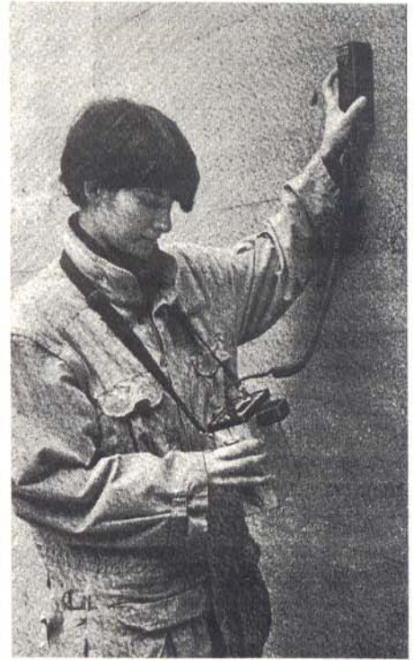
O localizador de armaduras determina a posição, profundidade e o calibre das barras que formam as armaduras
