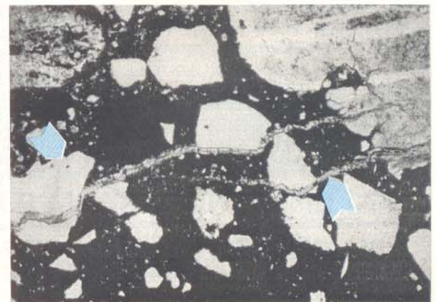
Figura 3: Uma seção, ao microscópio, de um concreto com diagnóstico R.A.S. expansiva. Micro trincas parcialmente cheias com gel alcali sílica (setas) estende-se a partir do sílex reativo (acima a direita). A reação provoca uma quantidade grande de erupções em uma laje de uma garagem de um shopping nos EUA.
