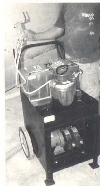
Bomba posiload com os reservatórios A e B acima e o reservatório do solvente a frente. A pistola está acoplada ao reservatório do solvente para limpeza. Dentro do compartimento, embaixo, está o motor(esquerda) e as duas bombas, tendo a frente os dois eixos que permitem fazer a relação de mistura para cada material (A e B)
