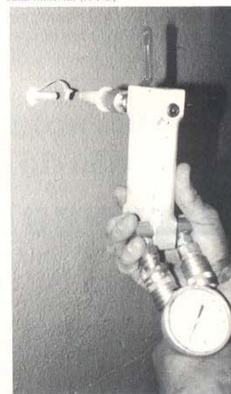
A pistola de injeção com as duas mangueiras que chegam a mesma e os respectivos manômetros. Dentro estão os misturadores.
