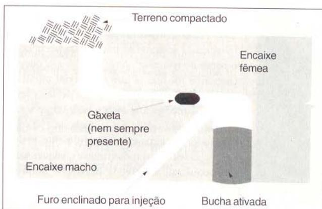
Seção da junta da galeria que obedece ao padrão de encaixe macho/fêmea e o esquema de tratamento. Veda-se a boca da junta e fura-se inclinado para se ter acesso ao interior da mesma, injetando-se a seguir.
