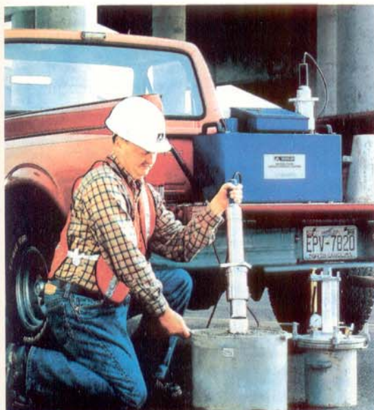
Este equipamento mede a relação água/cimento em minutos com extrema precisão.
