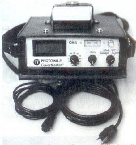
Este detector de armaduras com display digital mede espessuras de recobrimento de até 10cm, emite sinal de áudio e é sensível a armaduras com calibre de 6mm até 40mm de diâmetro. Trabalha com bateria ou ligado em fonte de 110 volts.
