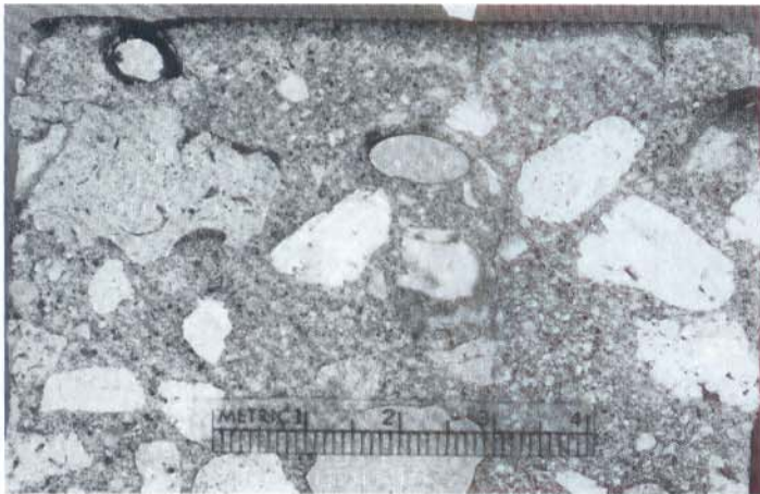
A etringite preenche e envolve bolhar de ar.
