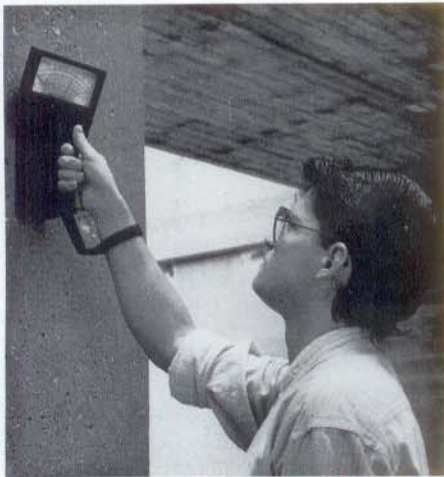
Este é um detector de armaduras tradicional, não digital, bastante utilizado.
