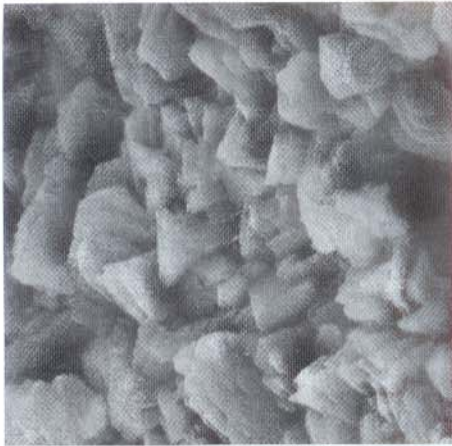
Carbonato de cálcio, bem cristalizado, existente na interface da pasta do concreto com a armadura exposta e corroída da foto da página 22 (C).
