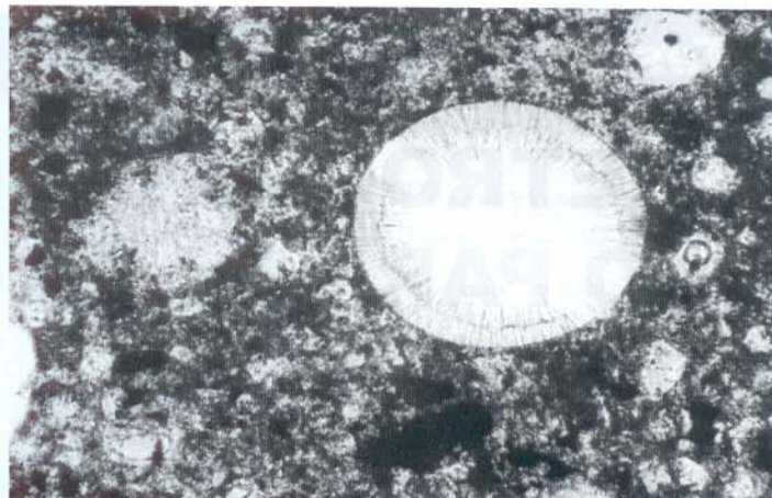
Trincas e descoloração devidas ao fogo.
