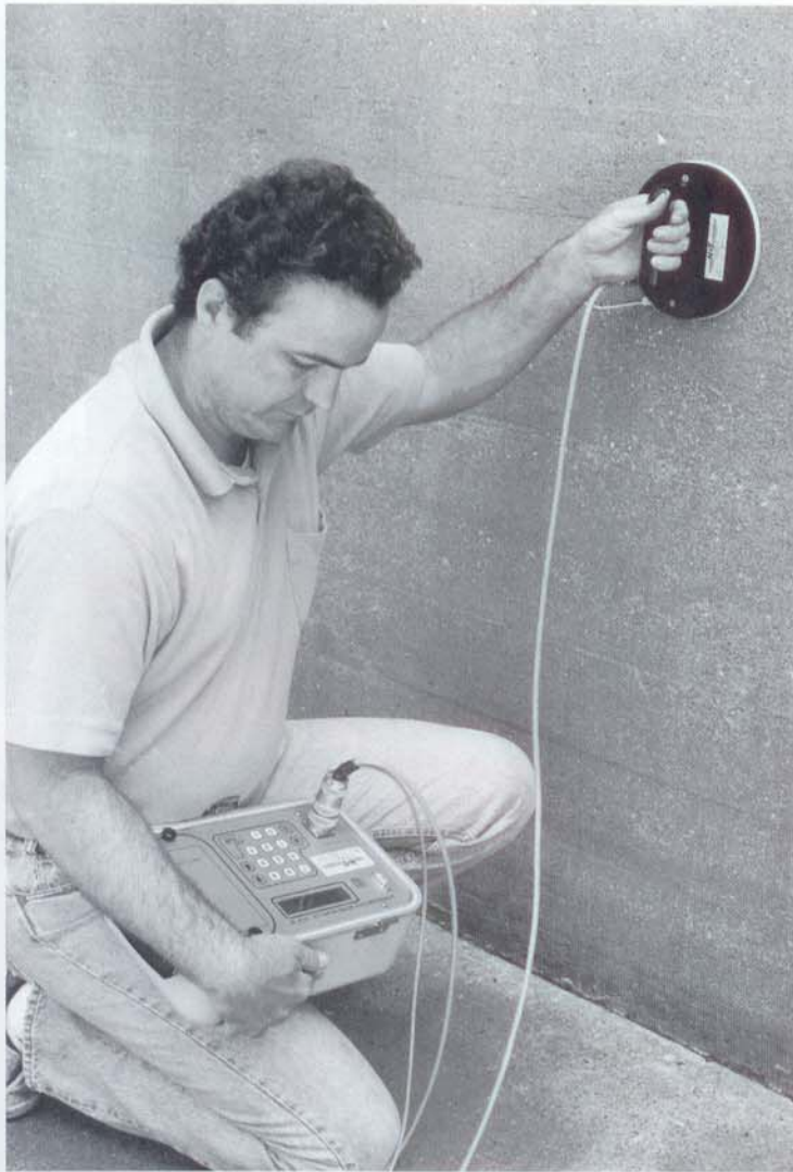
Este medidor da taxa de corrosão para o concreto armado, o GECOR, é um dos mais completos equipamentos para esta finalidade.
