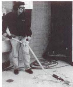
Martelo Descascador Pneumático - Chisel Scaler
