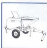
Quando se compra concreto e o lugar é de difícil acesso, normalmente necessita-se de uma bomba para transportar o material da betoneira até as peças a serem concretadas.
