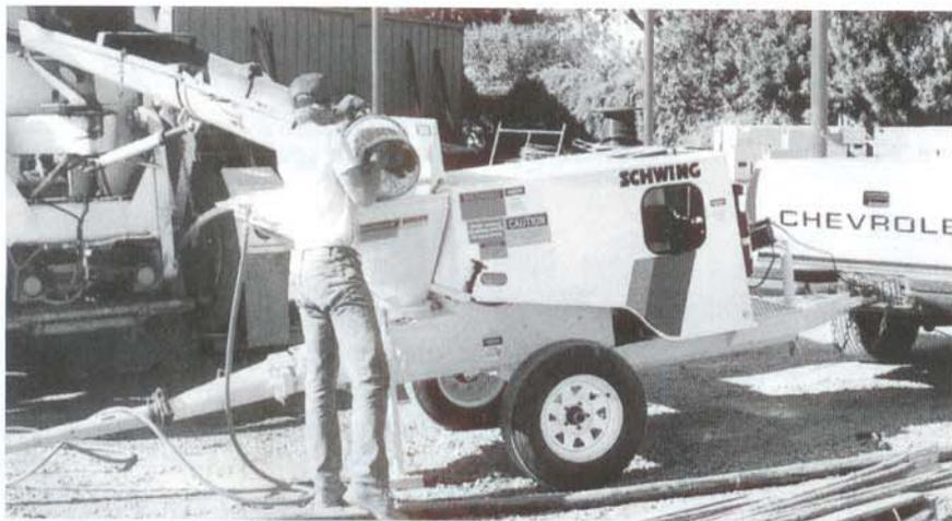
O primer, no início de cada lançamento e a cada 10m<sup>3</sup>, é o passo principal para não ter problemas com entupimentos, desgaste excessivo no equipamento e diminuição na pressão de trabalho da bomba.
