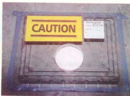
O kit que verifica a taxa de transmissão de umidade aplicado em um piso.
