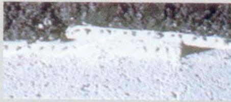
Vista em corte de um piso de concreto tratado com o PIB. Repare a hidratação do graut bentonítico.
