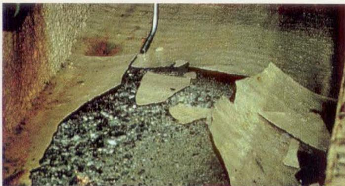
A preparação inadequada da superfície e a ausência de protetor penetrante condenaram este revestimento. Note que a película tornou-se "estranha" à superfície. O ataque ao concreto e ao subsolo é intenso.
