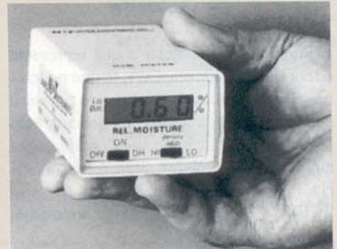
O medidor da umidade pelo teste do campo eletromagnético (TCEM). Basta encostar na superfície
