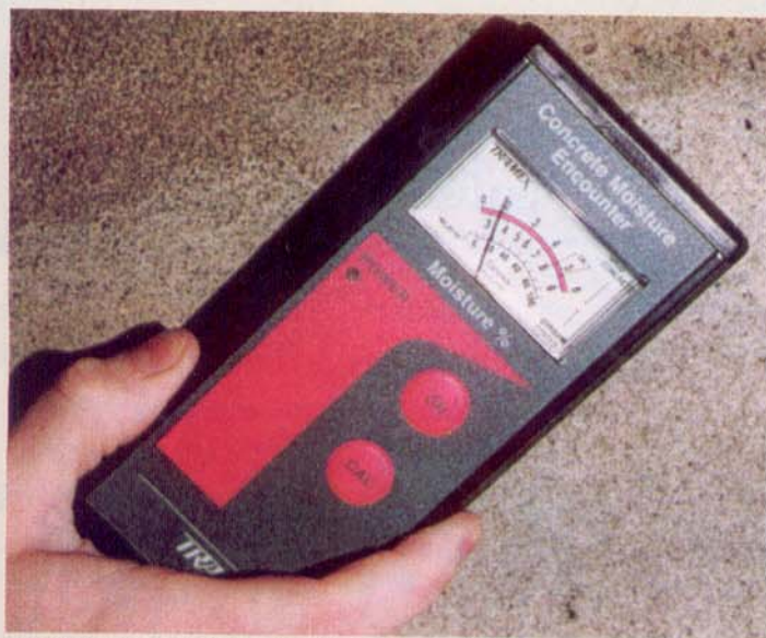
O medidor da umidade pela frequência de rádio (TFR).
