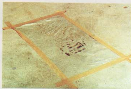
O teste do filme de polietileno (TFP).
