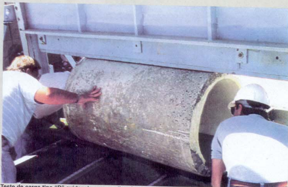
Teste de carga tipo "D" evidencia que a aplicação de sistemas de PVC dobram e até triplicam a resistências de tubulações.
