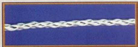
O eletrodo de monitoramento. Trata-se de um cabo de prata-cloreto de prata com \pm 5 mm de diâmetro.
