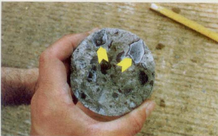
Corpo de prova com RAS extraído de uma peça estrutural. Note os depósitos brancos no em torno de diversos agregados escuros. Estes depósitos contêm o gel da RAS, que caracterizam a reatividade do agregado (setas).
