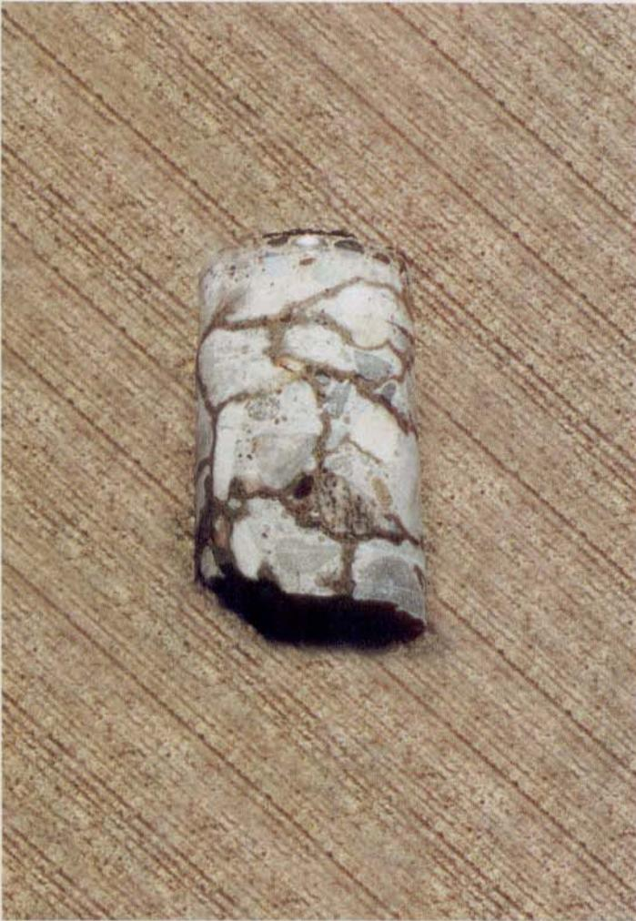
Corpo de prova, com 10cm de diâmetro, tirado de um tabuleiro de uma ponte confirmando a existência da RAS. Dez meses após a aspersão do produto RENEW, a interrupção do processo de expansão.
