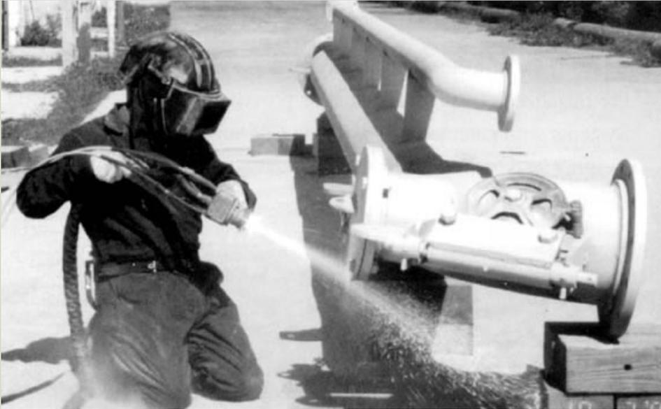
A aplicação do zinco termo projetado (ZTP) é simples e extremamente rápida.
