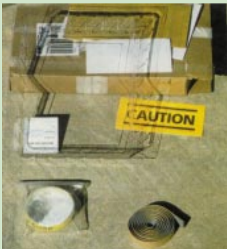
O kit do TVA-OK para indicar a taxa de vapor d'água inclui um prato que contém o cloreto de cálcio, uma cobertura plástica e um rolo de fita para vedação de cobertura plástica.
