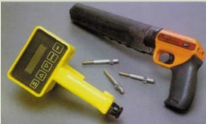
Figura 2 - O uso do penetrômetro é muito importante para se analisar a real resistência à compressão do concreto em sinistros por fogo. Nesta situação não se usa esclerômetros.
