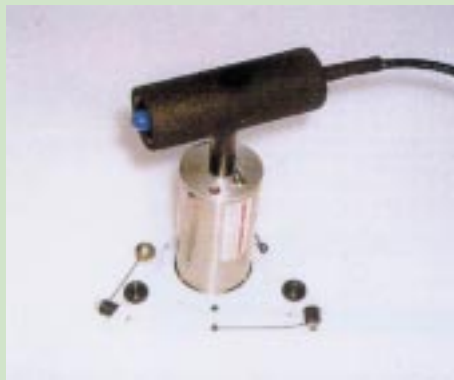
O eco-impacto tem a opção de vários tipos de percussores: à esquerda está o que tem 3 batedores. O da direita oferece 8 batedores.
