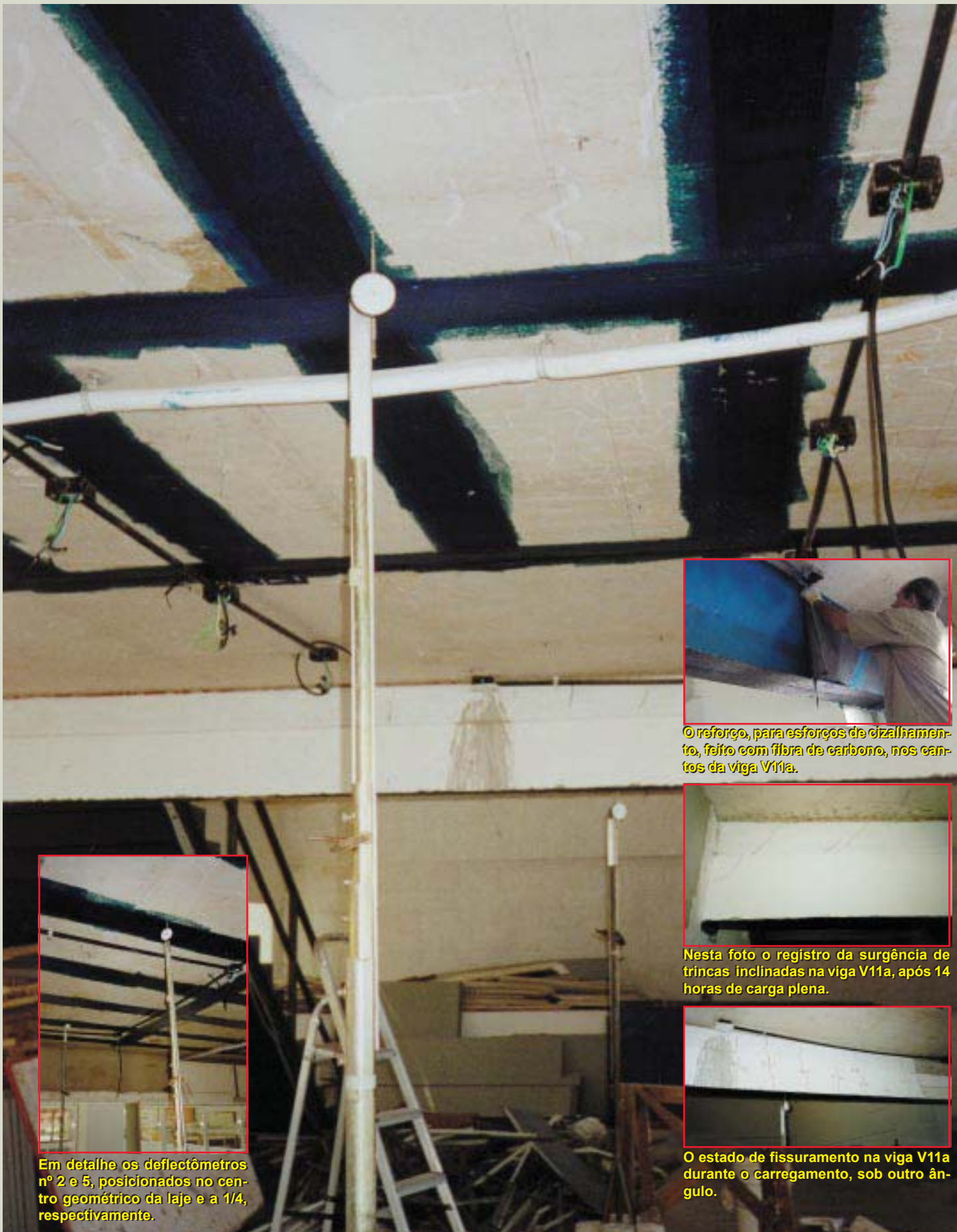
Vista dos deflectômetros nº 1 e 6 - posicionados sob a região inferior da laje e da viga V11a, respectivamente.
