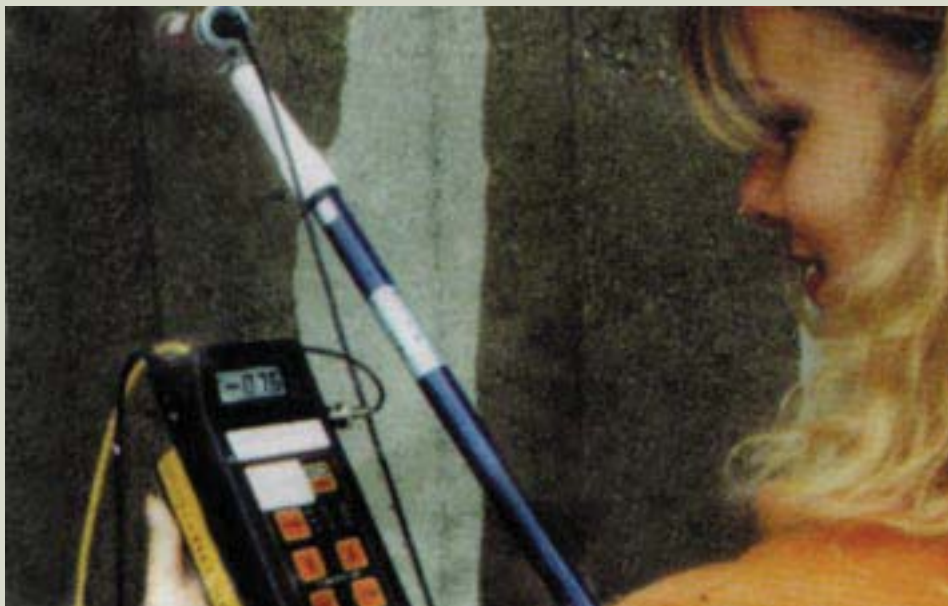
Poder-se-á adaptar hastes ao eletrodo, de modo a facilitar a busca dos potenciais.
