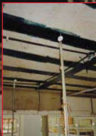
Em detalhe os deflectômetros nº 2 e 5, posicionados no centro geométrico da laje e a 1/4, respectivamente.
