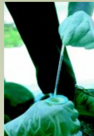
...Insere-se o pó no recipiente plástico com o reagente. A sonda informará o teor de contaminação por cloretos.
