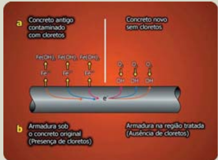
Figura 13 - Aqui fica mais claro a armadilha em que nos metemos ao executar uma recuperação numa estrutura com presença de cloretos. A área aparentemente boa torna-se, agora, um grande anodo.
