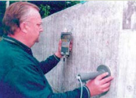
Figura 8 - Equipamento de controle da corrosão com “prato de eletrodos”.
