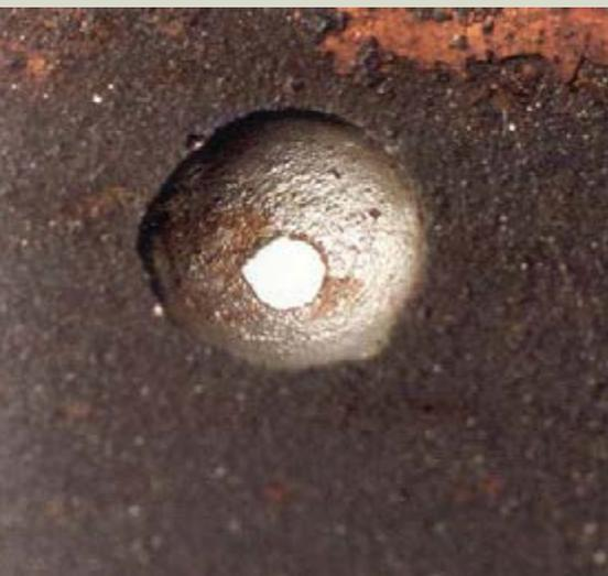
Pite com perfuração em parede de tubulação de aço carbono, tipificando BRS (1,5X).
