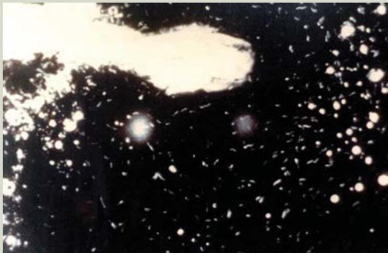
Microfotografia de um fluido escuro tomado de um pite existente sobre aço carbono (1000X). Note as células em forma de espirais, típicas da BRS.
