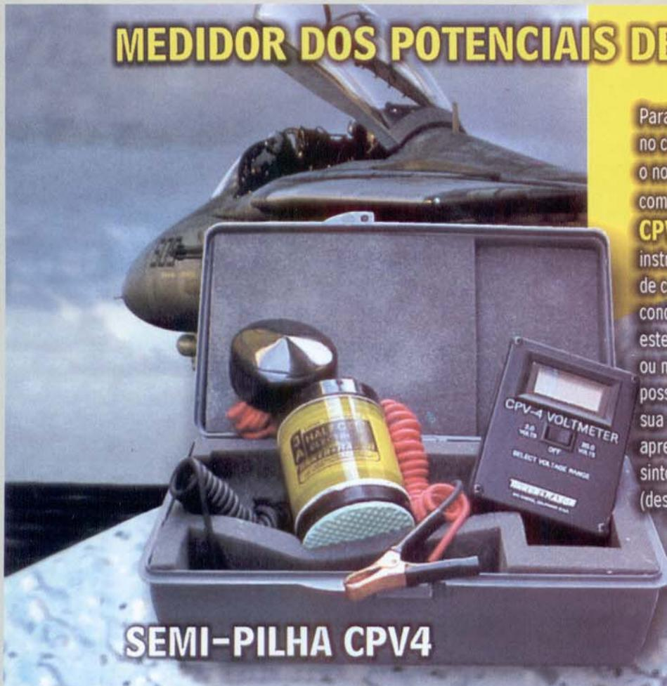
Para medir os potenciais de corrosão no concreto armado, já está disponível o novo conjunto semi-pilha **CPV-4** com voltímetro digital. A semi-pilha **CPV-4** é um revolucionário instrumento que mede os potenciais de corrosão em superfícies de concreto armado e protendido. Com este equipamento poder-se-á levantar ou monitorar, de tempos em tempos, possíveis estados de corrosão e a sua evolução, antes que a estrutura apresente sinais de ruína por sintomas de corrosão (deslocamentos).
