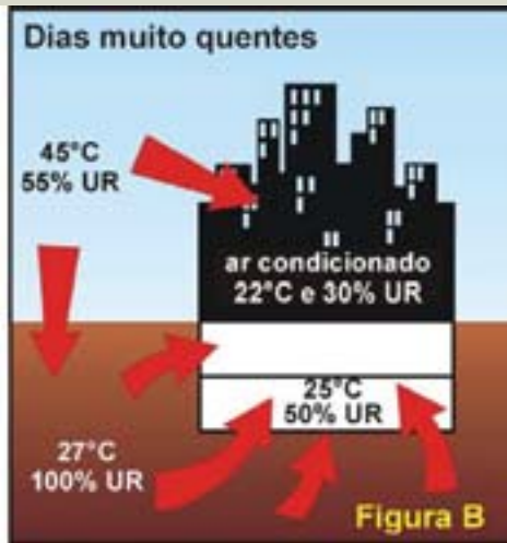
Estas duas figuras mostram como torna-se perpétuo o fluxo de vapor para dentro do subsolo. O mesmo não ocorre com a parte superior interna da edificação, que inverte completamente o fluxo.
