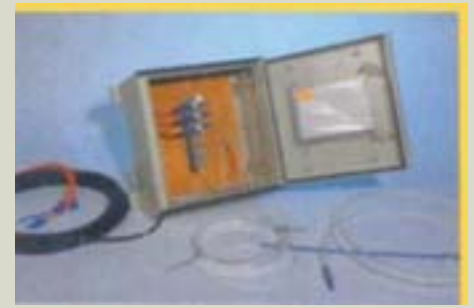
Os sensores de fibra ótica, a caixa de medição e os fios.
