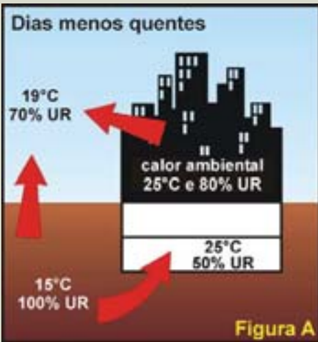
Estas duas figuras mostram como torna-se perpétuo o fluxo de vapor para dentro do subsolo. O mesmo não ocorre com a parte superior interna da edificação, que inverte completamente o fluxo.
