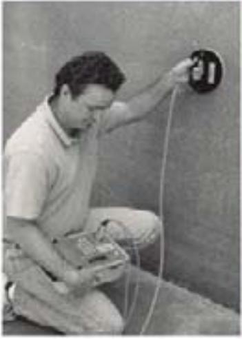
GECOR 8, o mais moderno equipamento de campo que mede a velocidade de corrosão e outros parâmetros das armaduras.
