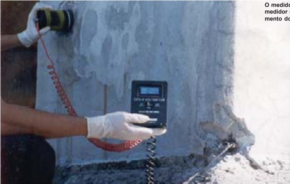
O medidor de potenciais (semi-pilha) juntamente com o medidor de resistividade (RESI) são fundamentais no levantamento do estado de corrosão no concreto armado-protendido.
