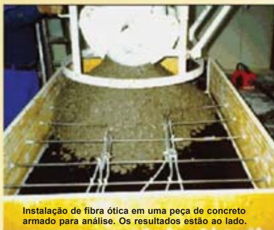
Instalação de fibra ótica em uma peça de concreto armado para análise. Os resultados estão ao lado.
