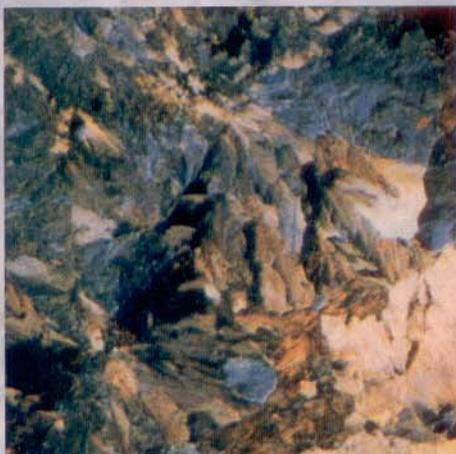
Montanhas mágicas. Esta microfotografia eletrônica mostra o aço com 0,8% de carbono usando contraste com interferência diferenciada.
