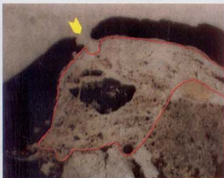
Figura 7 - A seta indica o rompimento da película do EBA provocado pela pressão de expansão do processo de cristalização do gesso. Passamos um linha vermelha em torno da região da pasta totalmente alterada.
