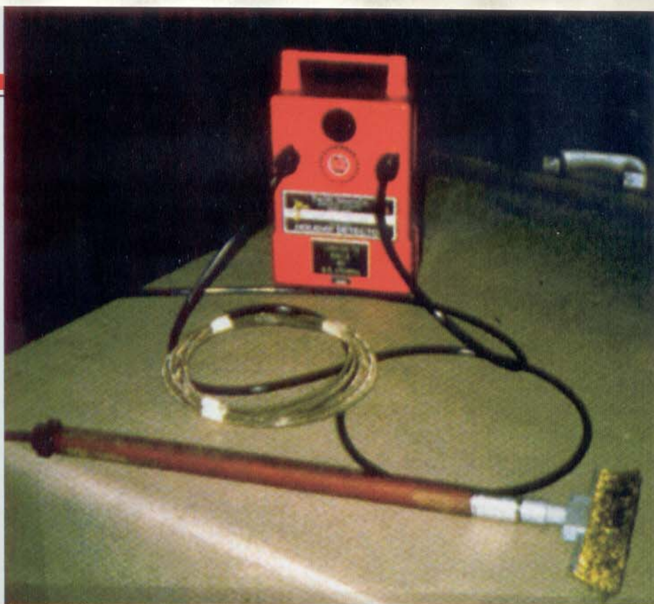
Figura 2 - O busca-furos de alta voltagem.
