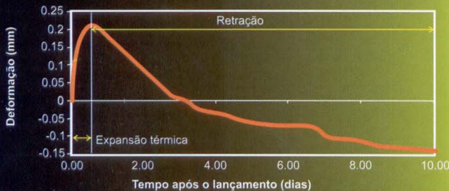
Figura 5 - Medida típica, feita pelo sensor padrão, de uma peça de concreto recém executada.
