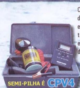
CPV4 mede os potenciais de corrosão em superfícies de concreto armado e protendido. Com este equipamento poder-se-á levantar ou monitorar, de tempos em tempos, o estado de corrosão e a sua evolução, antes que a estrutura comece a ter deslocamentos e armaduras-expostas.
