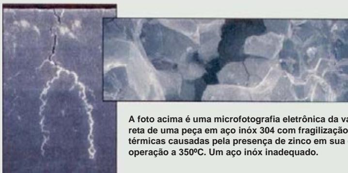
A foto acima é uma microfotografia eletrônica da varredura de uma seção reta de uma peça em aço inóx 304 com fragilização devido a tensões térmicas causadas pela presença de zinco em sua composição, quando em operação a 350°C. Um aço inóx inadequado.
