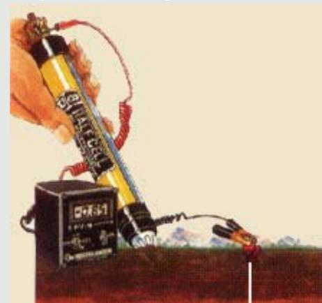
Semi-pilha CPV-4 (voltímetro e eletrodo) aplicado no solo.
