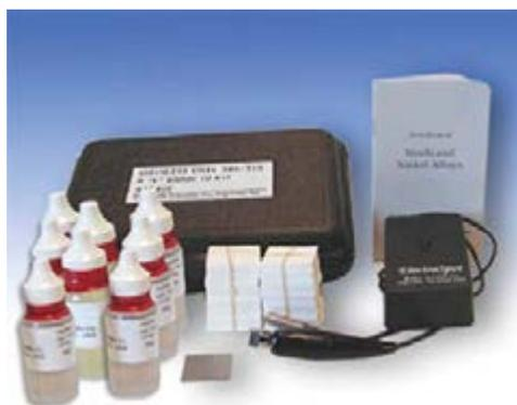
Com o identificador de ligas de alumínio LAB 1513 acabou-se o problema de identificação do tipo de alumínio nas situações de reposição, soldagem e recuperação. O LAB 1513 também identifica cobre, magnésio, manganês e zinco. É aprovado pelo ASTM 1476-95. Em segundos, sem necessidade de treinamento.
