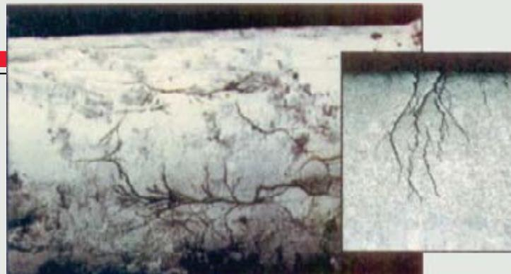
A foto maior é a de um tubo de grande diâmetro, em aço carbono, situado próximo à presença de fluidos ricos em cloretos, em uma indústria. O resultado são fissuras, diagnosticado como corrosão sob tensão, de acordo com a foto menor, uma seção em corte do tubo. É bastante comum o uso de metais inespecíficos a ambientes impróprios.
