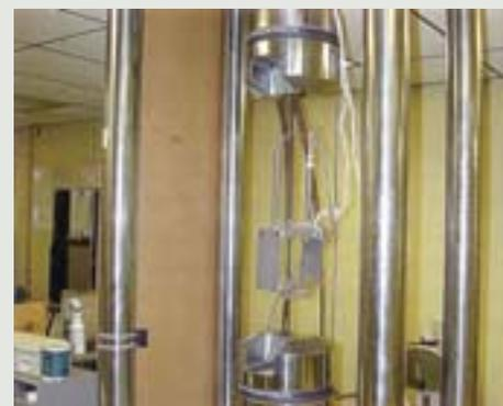
Figura 3 - A Fita MFC sendo testada em ensaio de tração.
