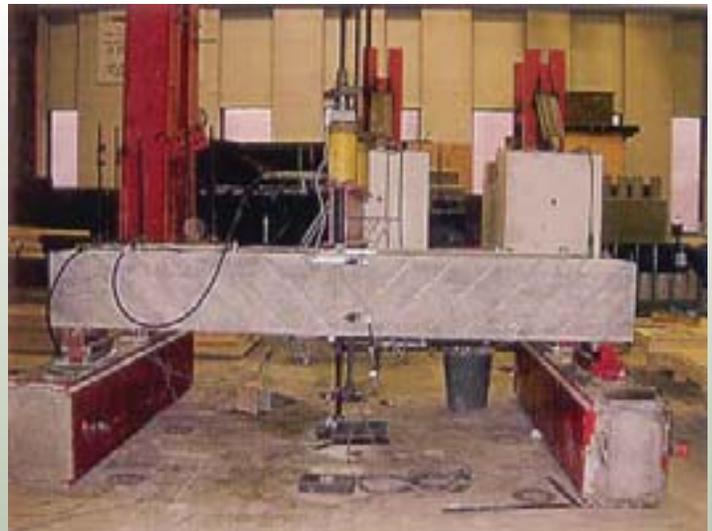
Figura 9 - Esta viga foi armada apenas com armadura de flexão, ou seja, sem qualquer estribo para atuação contra esforços de cisalhamento. Como se vê na foto, promoveu-se o reforço da condição de cisalhamento por ISS com a FITA MFC. À seguir, ensaiou-se até a rutura por escoamento da armadura de flexão.
