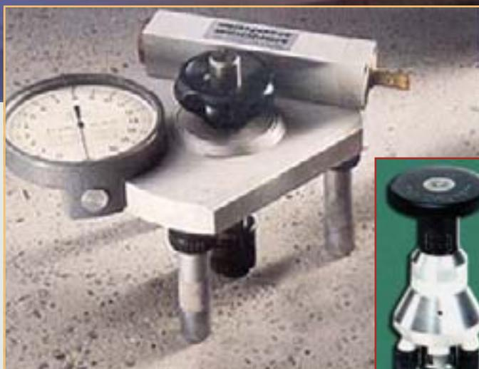
Os equipamentos para medir a adesão de tintas e revestimentos.
