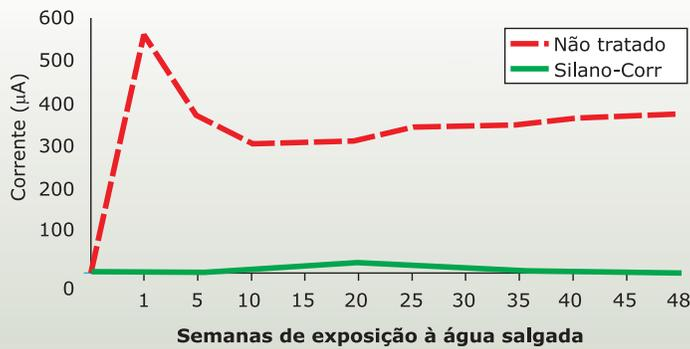
**Figura 3 - Resultados da aplicação do SILANO-CORR em corpos de prova novos, porém fissurados, sujeitos a ciclos de molhagem e secagem por 12 meses atacando-se com solução salina a 15%.**
