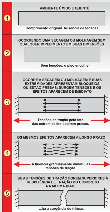
Figura 2 - Como ocorre o fissuramento.
