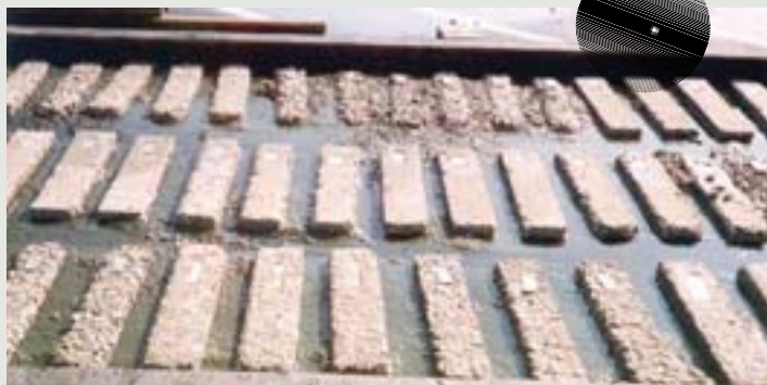
Amostras de todo tipo de concreto expostas a sulfatos.
