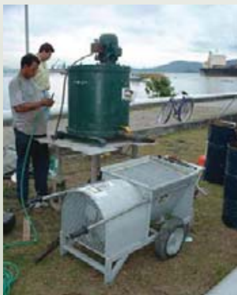
B Misturador e bomba de parafuso helicoidal: o equipamento do grouting.
