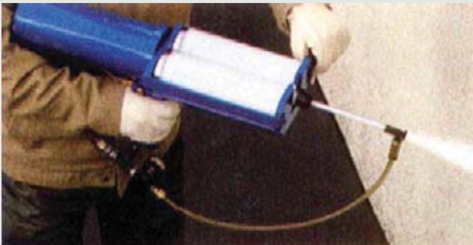
Figura 3 - Mais simplificação ainda para aplicação da poliuréia. Com esta pistola pneumática de duplo cartucho, alimentada por qualquer compressorzinho, você pode aplicar muitos tipos de poliuréia.
