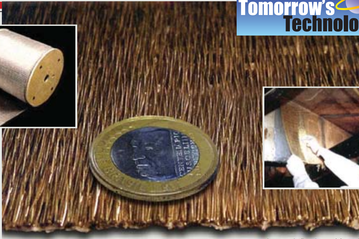
A manta de fios de aço é fornecida em rolos. Sua aplicação é tão fácil e rápida quanto a da fibra de carbono.
