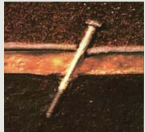
Capacidade de regeneração do compósito natural quando perfurado, impedindo a passagem de líquidos contaminantes.
