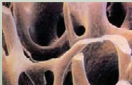
Simulação: a rede de vazios microscópicos presente em todo tipo de concreto.
