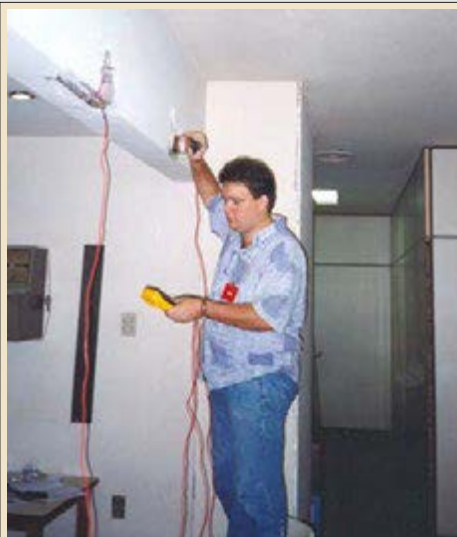
A análise dos potenciais da SEMI-PILHA é prática corrente em todo trabalho investigativo do concreto armado.
