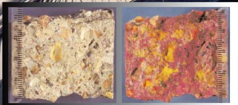
Amostra de concreto antes e depois (com a confirmação) da análise com o teste "Detector de RAS 3000". Este teste feito na obra qualifica e quantifica a presença de RAS.
