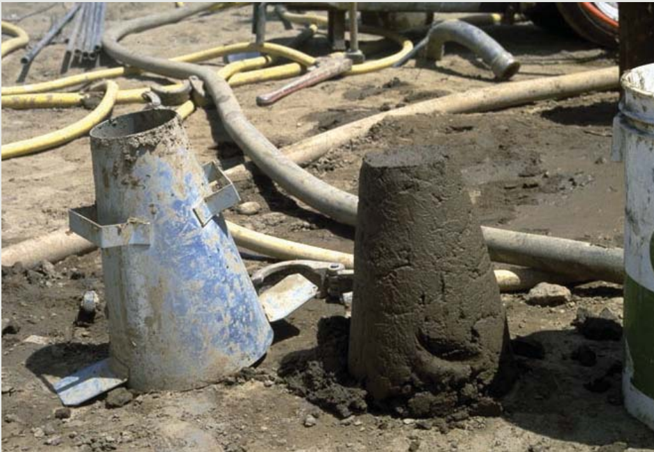
Figura 5 - A verificação do slump test que confirma a ausência de mobilidade do grout uma vez injetado.
