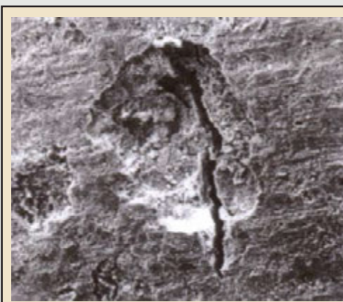
Figura 3 - Microfotografia eletrônica da superfície de um fio de cordoalha com pites e corrosão sob tensão fraturante (CTF). As carepas da superfície do pite foram limpas previamente.
