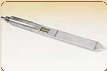
O medidor de tensões totais **TT 4830** é o menor e o mais avançado dispositivo para ser instalado em qualquer solo de fundação. É facilmente instalado, em qualquer profundidade. Mede a tensão total em qualquer solo e aterros. Caso se deseje também a tensão efetiva, o medidor **TT 4830** é instalado com um piezômetro. É fornecido com um cabo fino, fixado no aparelho, para permitir a instalação. Apresentam-se em diversos tamanhos.
