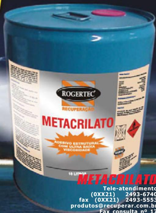
Com viscosidade igual a da água, o **METACRILATO** preenche e monolitiza qualquer trinca ou fissura existente em pisos e pavimentos com até 0,05mm de abertura. Basta verter o produto. O **METACRILATO** também monolitiza trincas e fissuras em vigas e pilares, de maneira fácil e rápida. É só fazer um pequeno furo na parte superior da peça e verter o produto com a ajuda de um pequeno funil. Não fique perdido no tempo das injeções.
