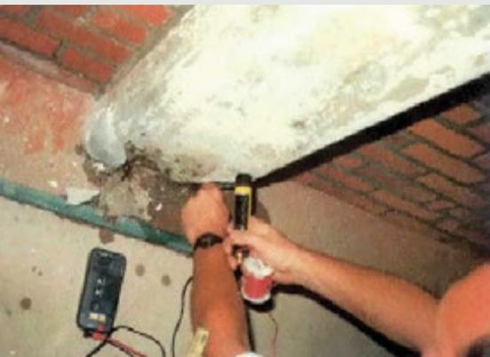
O teste com a semi-pilha preconizado pela ASTM C 876 posiciona os potenciais das armaduras com referência a atividade de corrosão na hora do teste. Um potencial de 350mV indica o início do processo de corrosão.
