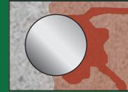
A expansão voluntária da corrosão causa trincas e deslocamentos.
