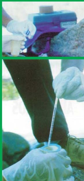
*Clor-test foi desenvolvido para analisar a contaminação em qualquer tipo de superfície. Seus componentes são pré-medidos, de modo a assegurar resultados precisos, em partes por milhão (ppm) e microgramas por centímetro quadrado ( $\text{mgr}/\text{cm}^2$ ), sem necessidade de qualquer correção em relação à temperatura ambiente. Em outras palavras: Clor-test é a precisão do laboratório na obra.*
