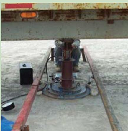
Prova de carga para determinar o coeficiente de recalque ou valor  $K$  para pisos e pavimentos de concreto.
