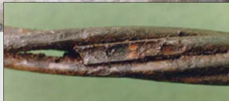
taminantes vulgo cloretos, sulfato, nitratos e o próprio oxigênio, fatores acelerantes de todo processo de corrosão. A técnica de diagnóstico da invasão do concreto com instrumento (a chamada técnica invasiva) de modo a tentar desvendar o que está ocorrendo lá dentro, ou mesmo retirar-se amostras da massa endurecida é considerado o primeiro procedimento investigativo da presença de corrosão.
