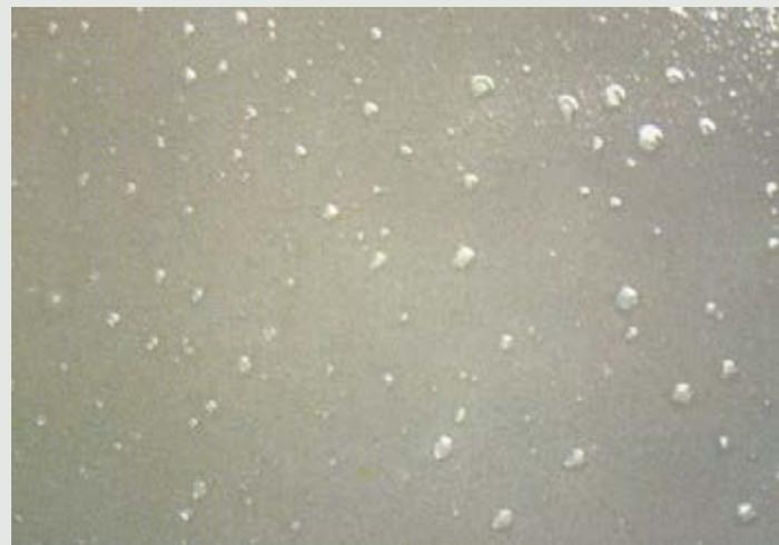
Figura 3 - Bolhas provocadas pelo solvente da formulação da tinta, que tenta evaporar e não consegue: formam-se bolhas do solvente. Muito comum quando se utiliza uma tinta, com solvente mais forte, sobre uma tinta de baixa resistência.
