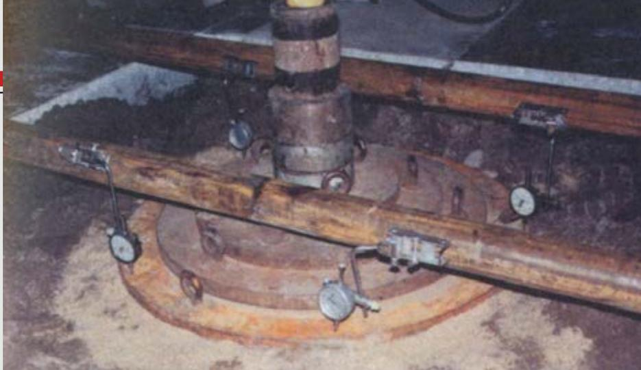
O dispositivo para prova de carga no solo.
