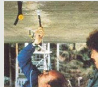
**Visualização do interior de um cabo após a furação. Utiliza-se um endoscópio.**
