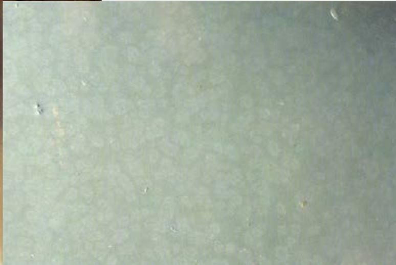
Figura 4 - Pintas ou manchas estampadas praticamente hexagonais (invisíveis ao olho humano), transparecendo que o pigmento da tinta está flutuando na superfície. Diferenças e incompatibilidades na concentração dos pigmentos utilizados na formulação da tinta.
