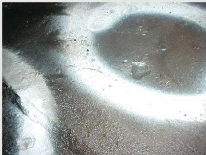
Enorme pite no piso de um tanque de combustível, com cerca de dois centímetros de diâmetro por dois centímetros de profundidade, descoberto durante uma inspeção interna. Repare que não há qualquer produto de corrosão na parte superior e entorno do pite.
