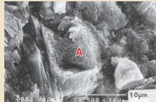
Figura 1C - Partícula de escória de alto forno (A) envolvida na hidratação da matriz cimentícia do concreto.
