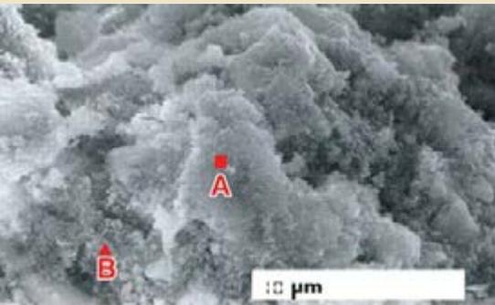
Figura 1A - Matriz cimentícia extremamente densa de um concreto com fumo de sílica. "A" são silicatos de cálcio hidratados. "B" são finos cristais de hidróxido de cálcio.
