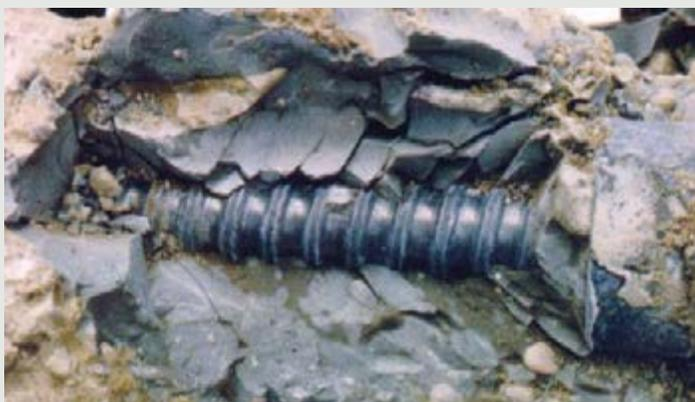
Figura 8 - A presença de qualquer abertura de trinca põe o fluido em contato com o aço, ao mesmo tempo em que altera a alcalinidade da calda endurecida.
