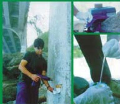
*Clor-test foi desenvolvido para analisar a contaminação em qualquer tipo de superfície. Seus componentes são pré-medidos, de modo a assegurar resultados precisos, em partes por milhão (ppm) e microgramas por centímetro quadrado (mgr/cm<sup>2</sup>), sem necessidade de qualquer correção em relação à temperatura ambiente. Em outras palavras: Clor-test é a precisão do laboratório na obra.*
