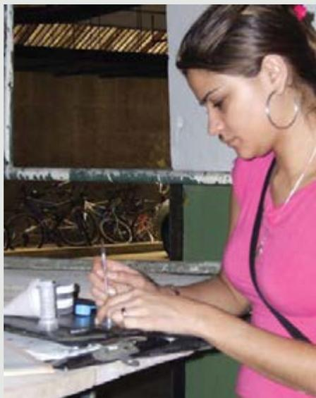
O Kit Detector de Cloretos quantifica e qualifica, na hora, a contaminação no concreto.
