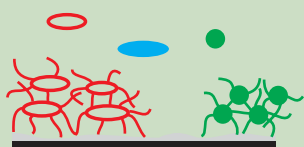
Estágio 3: Diferentes espécies de bactérias sésseis dobram para trás na superfície do metal.
