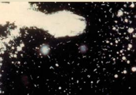
Figura 4 - Microfotografia de um fluido escuro tomado de um pite existente sobre aço carbono (1000x). Note as células em forma de espiras típicas da BRS.
