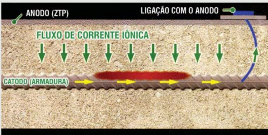
Figura 2 - Esquema de proteção catódica com zinco termo projetado (ZTP).
