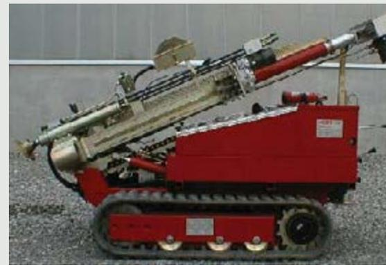
Modelo de CPT mecânico estático tradicional robotizado. Equipamento sofisticado e caro.
