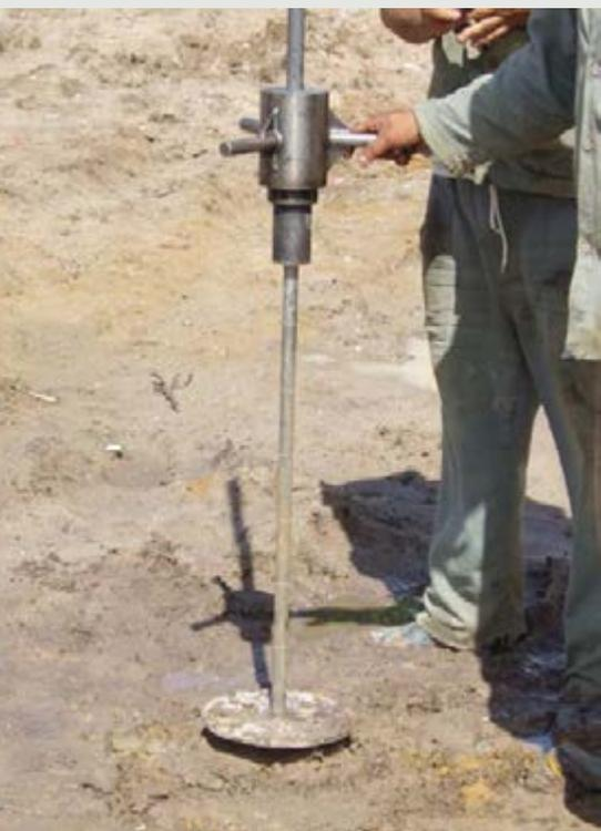
CPT dinâmico. O peso de 10kg descansando na base do equipamento. Sua haste de cravação é graduada em trechos de 10m.
