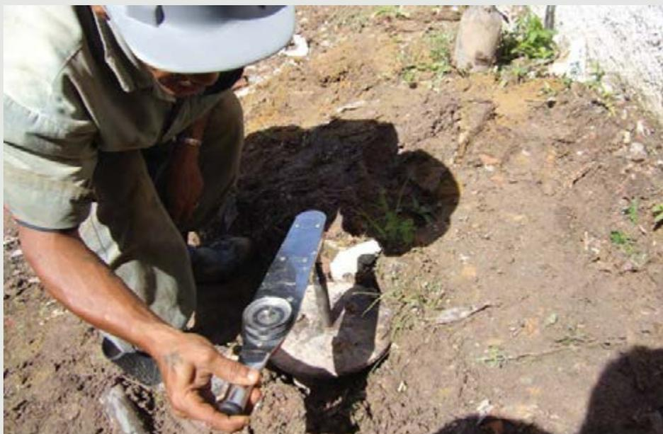
CPT dinâmico. O ensaio de torsão na haste após a cravação.
